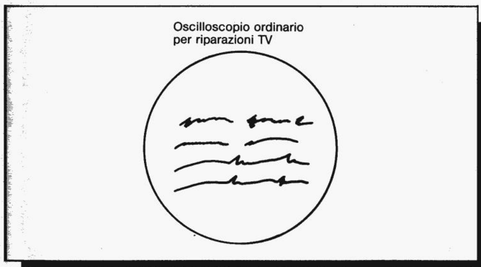
Figura 224. L'oscilloscopio ordinario per riparazioni TV può visualizzare facilmente i segnali che escono dal VIC. Al piedino 15, dovrebbe essere presente questo segnale TV di sincronismo e luminanza.
