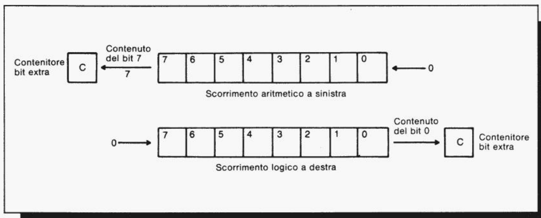
Figura 165. Durante uno scorrimento aritmetico a sinistra, uno 0 viene inserito nel bit 0, mentre il contenuto del bit 7 viene raccolto nel contenitore di flag C. Durante uno scorrimento logico a destra, uno 0 viene inserito nel bit 7, mentre il contenuto del bit 0 viene raccolto nel contenitore di flag C.
