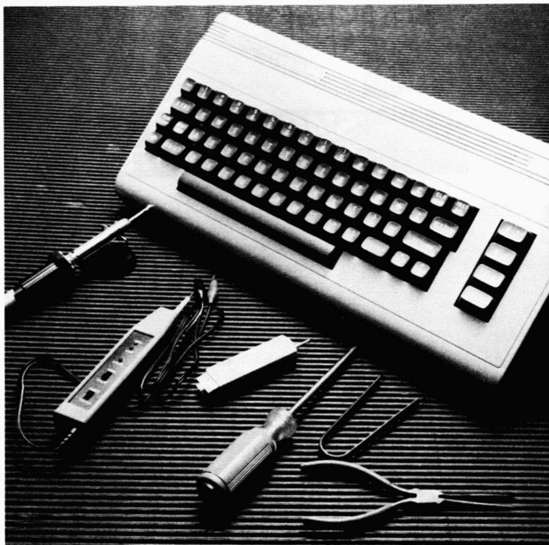
Figura 14. Il C-64 può essere smontato servendosi di un cacciavite con punta a croce. La piastra del circuito stampato viene rimossa con l'aiuto di un saldatore e di un paio di pinze a becco lungo.
