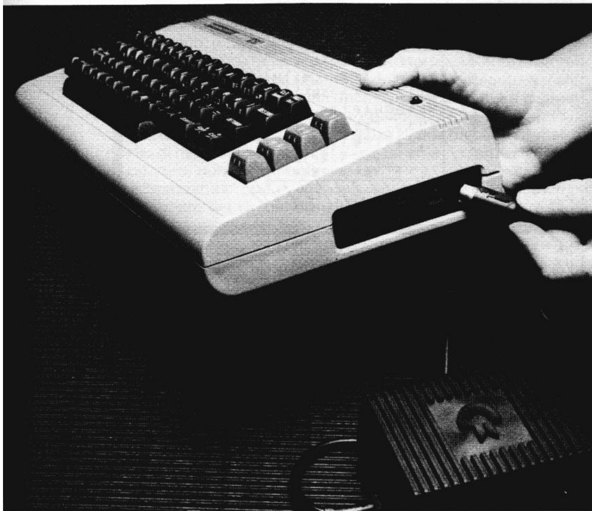
Figura 2. La prima azione da compiere, quando il C-64 non dà segni di vita, è quella di accertarsi che l'alimentatore sia collegato alla presa a muro e all'apposito connettore laterale del computer.
