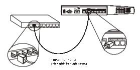
Un nodo finale può essere connesso mediante connettore Uplink ma in questo caso è necessario utilizzare un cavo incrociato o un convertitore.
