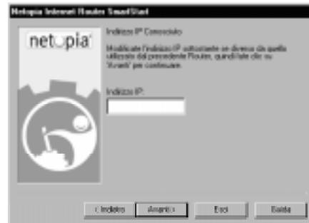
**Schermata Nuovo indirizzo IP.** Se si desidera modificare l'indirizzo IP del router, inserire in questa schermata il nuovo indirizzo IP, la maschera di sottorete e il numero di serie del router. Ricordatevi che il numero di serie si trova sul fondo del router ed anche nella vostra documentazione.
