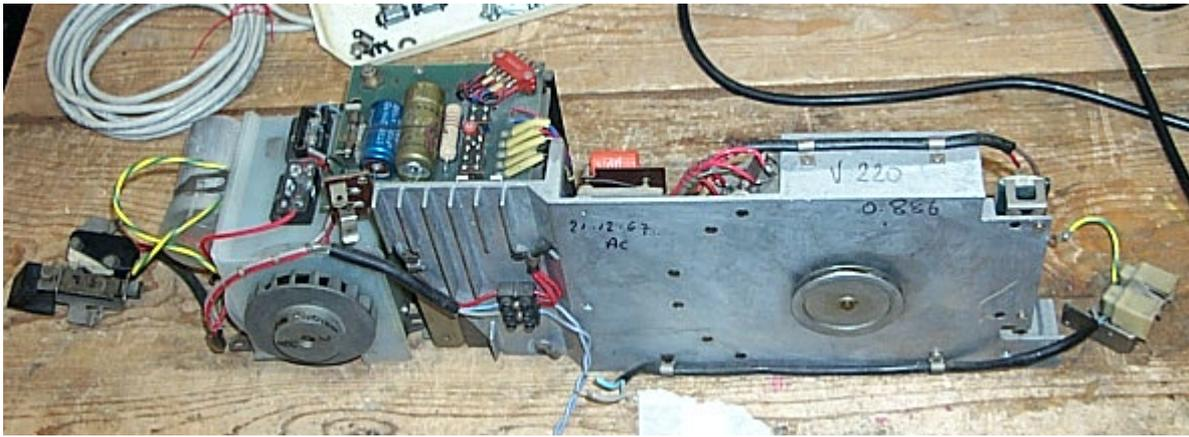
Questa cinghia puo' essere sostituita con un O-Ring spessore ... e diametro ... mm
