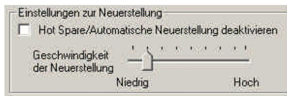
Das Kontrollkästchen „**Disable Hot Spare/Auto Rebuild**“ deaktiviert die Möglichkeit einer Wiederherstellung auf einem „Hotswap“-Ersatzlaufwerk oder die automatische Wiederherstellung eines Spiegel-Arrays. Die Standardeinstellung ist nicht markiert (d.h. Hot Spare/automatische Wiederherstellung aktiviert).
