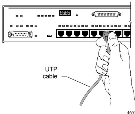
**Figure 3-9. Model 281xSA hub 10BASE-T port connection**
